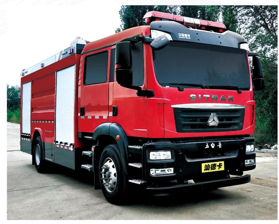
该车是应用新技术新工艺,使用新材料,自主研制的应急救援产品;水罐消防车设计承载水7850kg;泡沫消防车设计 承载水5950kg, B类泡沫1900kg。整车设计理念与国际行业标准相衔接,整车设计结构与国际行业标准接轨。
