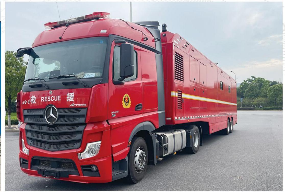
该车是最新研发的通信类半挂车产品之一,产品采用后双桥结构,整车空间大,通信设备及功能齐全。底盘悬架 型式为空气悬架,拓展式箱体,主要用于现场通讯及应急信息传输等。
